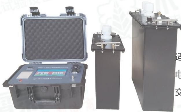
主机                      30kV 升压器      50kV 升压器
