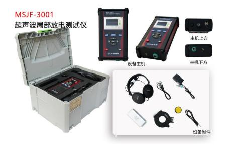
MSJF-3001 局部放电检测仪,适用范围:采用非侵入式检测方式,对高压电气设备的局部放电缺陷进行检测及定位。传感器配置标配:超声波传感器(UA)、地电波传感器(TEV)、选配:变压器专用传感网、GIS 专用特高频传感器、高压电缆专用传感器,也可根据用户要求定制。检测原理:超声波法(UA)、地电波法(TEV)及特高频法(UHF)。
